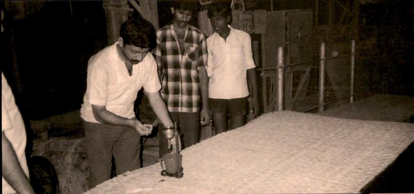
Les panneaux de bambou sont un matériau de construction polyvalent qui peut servir à la fabrication de portes, murs intérieurs, meubles, boîtes et autres produits.
