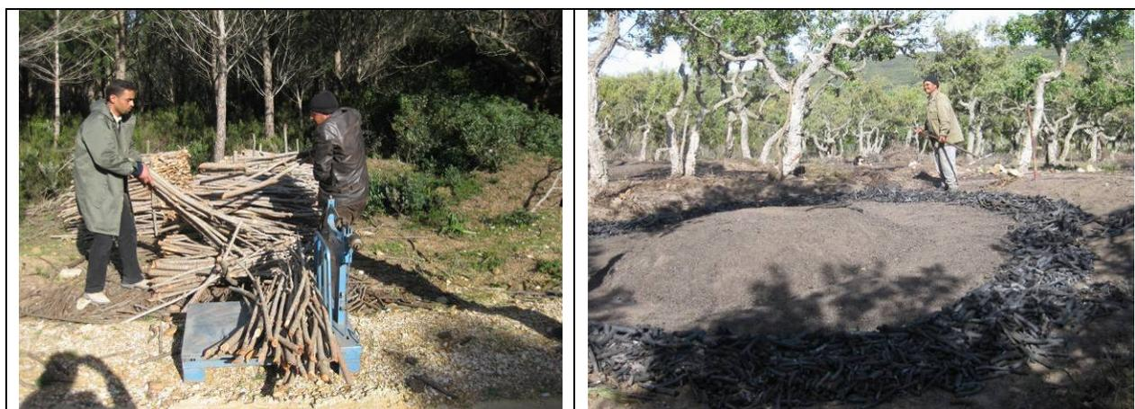
Figure 40 : Expérimentation de carbonisation des sous produits d'élagage
