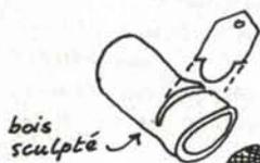
bouchon en bois recouvert d'un morceau de chambre à air
