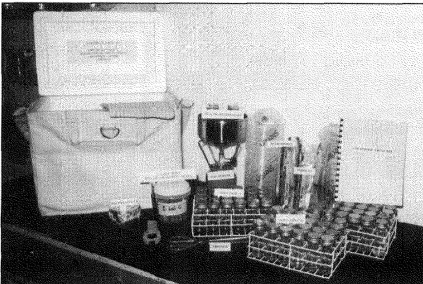
*La trousse portative contient l'équipement nécessaire pour établir la contamination des puits dans les régions éloignées.*
