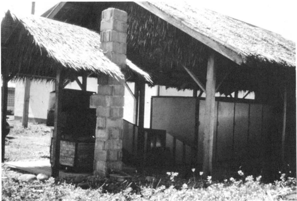
Fig. 4. Séchoir chauffé avec des balles de riz dans un village de pêche de Mercedes, aux Philippines.
