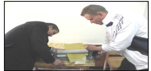
Photo 03: Phase de gaufrage de la cire (Bénéficiaire entrains de travailler)
